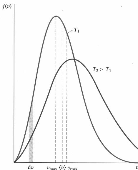
Die Verteilung der Molekülgeschwindigkeiten eines Gases bei zwei Temperaturen, wobei  $T_2 > T_1$  ist. Die Fläche  $f(v)dv$  ist gleich dem Anteil der Moleküle, deren Geschwindigkeiten im engen Intervall  $dv$  bei der Geschwindigkeit  $v$  liegen. Die mittlere Geschwindigkeit  $\langle v \rangle$  und die quadratisch gemittelte Geschwindigkeit  $v_{\text{rms}}$  sind etwas größer als die wahrscheinlichste Geschwindigkeit  $v_{\text{max}}$ .
