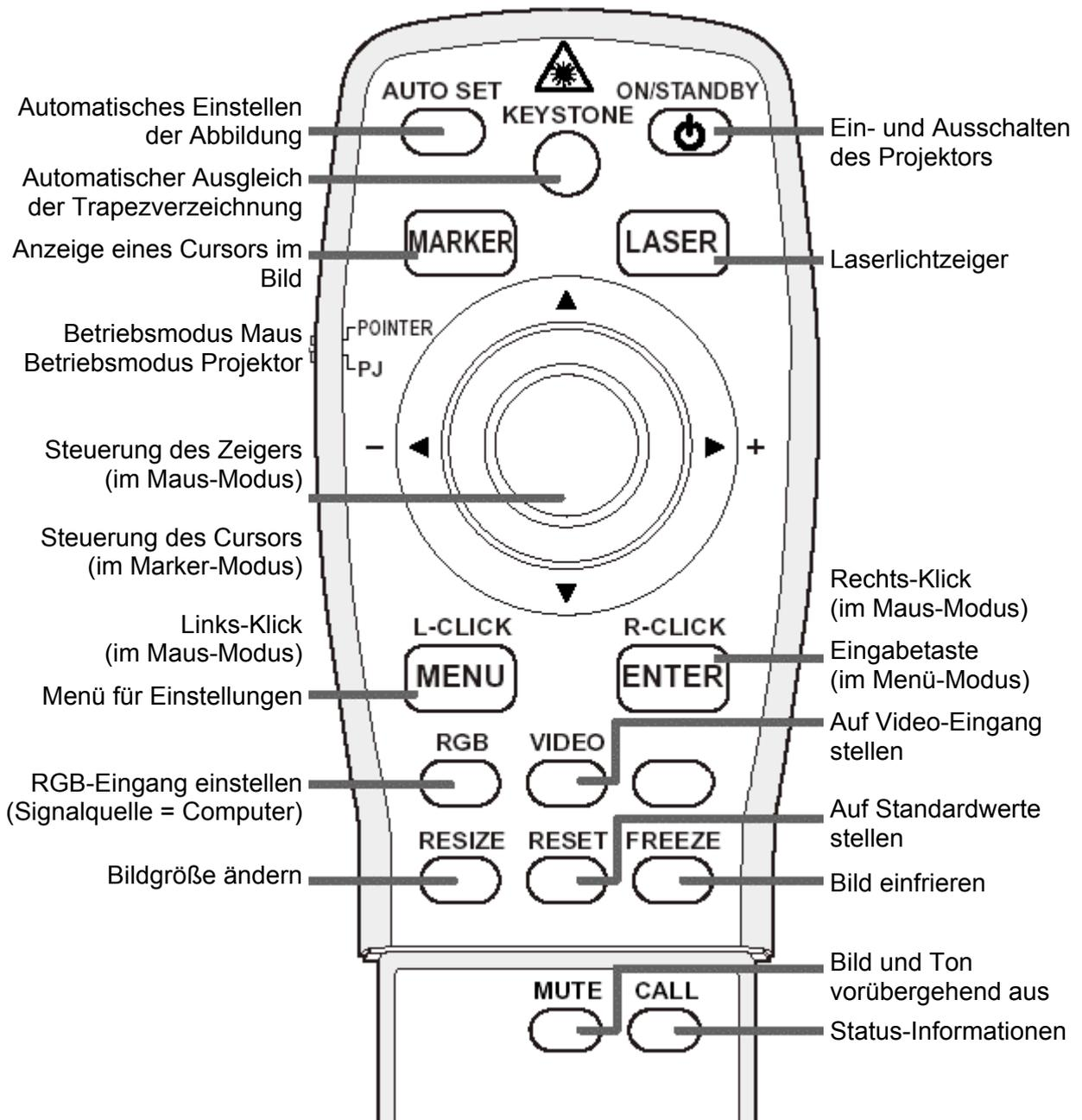
Wenn die Fernbedienung zur Maussteuerung (Pointer-Modus) verwendet werden soll, muß der „Remote Mouse Receiver“ an der Lehrerstation angeschlossen sein und die Fernbedienung dorthin gerichtet werden. Die Reichweite beträgt ca. 5m.
